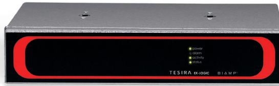
Tesira EX-LOGIC是一种半机架逻辑盒，与Tesira SERVER和SERVER-IO设备一起使用。EX-LOGIC同时提供逻辑输入和输出，是通过软件进行配置的控制界面。共有16个连接可用作输入或输出。其中12个连接仅可用作逻辑连接，用作逻辑输入时仅接受触点闭合或5V TTL输入，每个输出通道最大为40V/500mA。其余4个连接也可以用作逻辑连接，或者用作可变电压控制输入(例如电位器接口)。16个连接可用作LED驱动。EX-LOGIC还提供命令字符串输入的串口，可用于向系统的其它设备发送动作命令。EX-LOGIC与Tesira网络通讯，用于音频传输、配置和控制，并由PoE供电。
